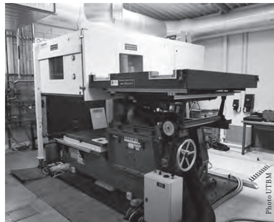
Plateforme d'essais vibroclimatiques sur matériel lourd
